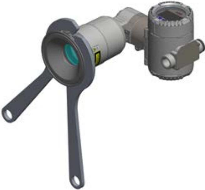
**Figura 30** Desmontaje de la brida con llaves
