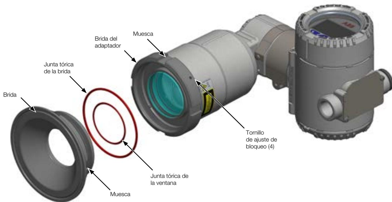
**Figura 31** Montaje de la ventana de brida higiénica
