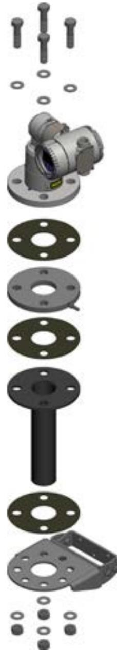
**Figura 47** Instalación del modelo LLT100 en entornos polvorientos
